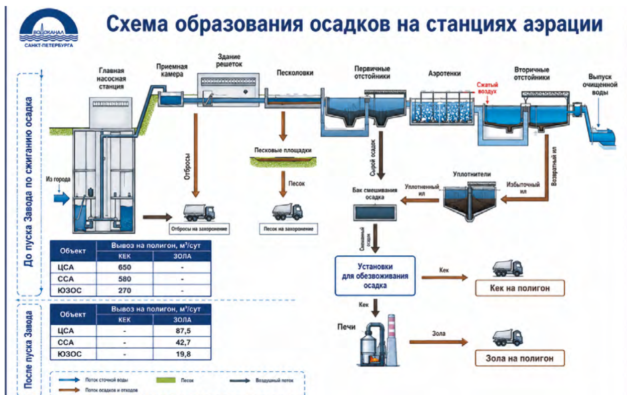
Рисунок 1. Схема образования осадков на станциях аэрации
